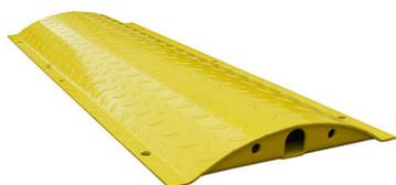
Ralentisseur en acier (épaisseur 5 mm) permettant de réduire la vitesse à 25 km/h (hauteur du ralentisseur 48 mm) sur les voies de circulation privées (site industriels, garage, parking, stations service etc. ...).
