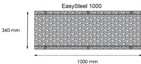
Ralentisseur en acier (épaisseur 5 mm) permettant de réduire la vitesse à 25 km/h (hauteur du ralentisseur 48 mm) sur les voies de circulation privées (site industriels, garage, parking, stations service etc. ...).
