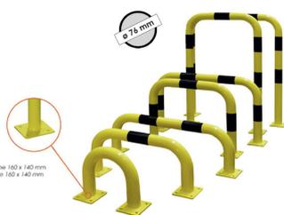
Arceau de protection métal servant à protéger les équipements ou les machines des coups éventuels portés par les engins de manutention. Ils sont fabriqués en acier épaisseur 3 mm , avec platine de fixation à 4 trous. Ils permettront d'améliorer grandement la sécurité dans les zones à risques. Les fixations ne sont pas incluses. Prévoir 8 fixations [BARFIX1SB](#).
