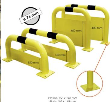
Arceau de protection métal anti encastrément servant à protéger les équipements ou les machines des coups éventuels portés par les engins de manutention. Ils sont fabriqués en acier épaisseur 3 mm , avec platine de fixation à 4 trous. Ils permettront d'améliorer grandement la sécurité dans les zones à risques. Les fixations ne sont pas incluses. Prévoir 8 fixations [BARFIX1SB](#).
