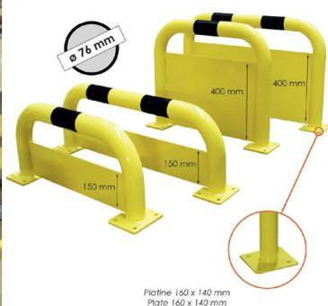
Arceau de protection métal anti encastrement servant à protéger les équipements ou les machines des coups éventuels portés par les engins de manutention. Ils sont fabriqués en acier épaisseur 3 mm , avec platine de fixation à 4 trous. Ils permettront d'améliorer grandement la sécurité dans les zones à risques. Les fixations ne sont pas incluses. Prévoir 8 fixations [BARFIX1SB](#).
