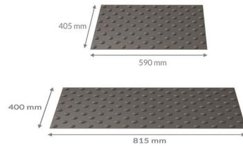
La bande d'éveil de vigilance podotactile WACCESS® se positionne avant et parallèlement à une zone à risque (escalier, vide, traversée dangereuse, passage pour piétons, quai de métro...) pour alerter du danger de chute toute personne s'en approchant.
